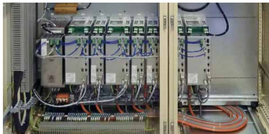
多轴压制系统受益于 SD2 驱动系统的直流电压耦合。压制过程可高度动态且高效实施。
