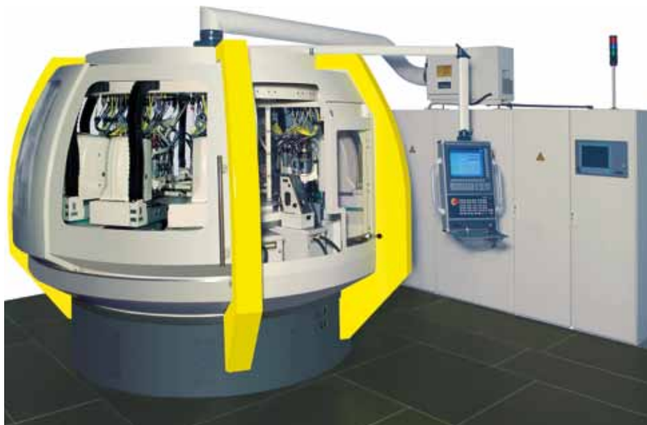
在旋转输送机中，SD2 可以优化其优势，例如多轴功能、集成安全功能以及负载指示器。
